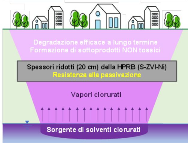
Figura 2: Seconda tecnica di mitigazione sviluppata basata sull'uso di barriere reattive orizzontali (HPRB) poste tra edifici e sorgente costituite da materiali a base di ZVI per indurre la degradazione dei vapori clorurati e principali risultati.
