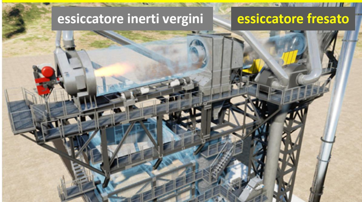
Il fresato esce dal secondo essiccatore ad una temperatura di 160°C, consentendo la produzione di un asfalto contenente fino al 100% di RAP senza surriscaldare i materiali inerti vergini nel primo essiccatore. Si risparmia energia e si preserva la qualità del bitume residuo nel fresato.
