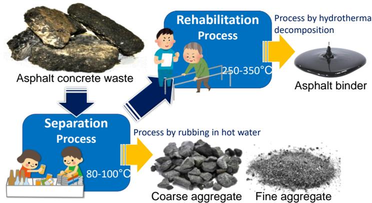
Ad elevate T e P l'acqua raggiunge proprietà simili a quelle di solventi organici favorendo la riduzione del peso molecolare e del grado di ossidazione del bitume invecchiato che tende a recuperare le proprietà chimiche e fisiche del bitume vergine.
